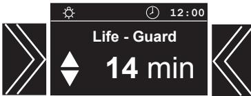
Nach Ablauf der „Life - Guard“ - Zeit wird der Saunaofen abgeschaltet und die eingestellte „Life - Guard“ - Zeit blinkt
